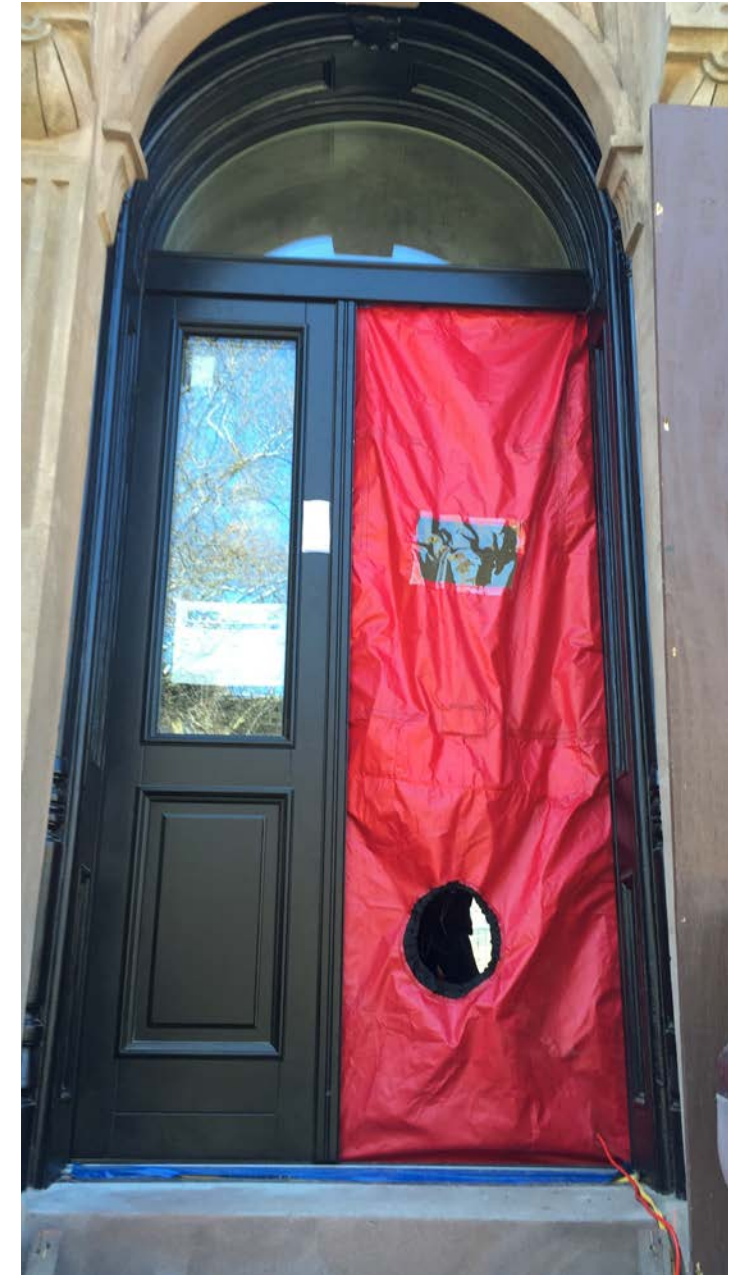
BLOWER DOOR TEST
